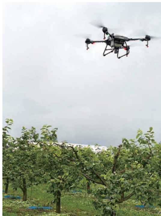
写真 かき樹の樹上2m上空を飛行し、水を試験散布するマルチローター(試験は地元企業の協力を得て実施)
