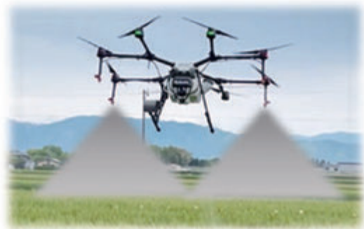
図1 ドローンによる薬剤散布のイメージ図 現在主流となっているMG-1シリーズは8枚羽で進行方向の前面2つのノズルから薬剤を散布する。
